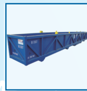
13.3m Cargo Basket 44' x 4' x 4'3" 13300 x 1220 x 1300 Gross: 15,000kg Tare: 3,000kg Payload: 12,000kg
