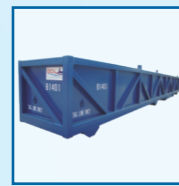
14.3m Cargo Basket 47' x 4' x 4'3" 14300 x 1220 x 1300 Gross: 15,000kg Tare: 3,200kg Payload: 11,800kg
